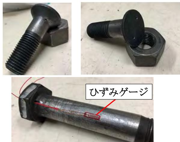
図 12 皿ボルトの孔あけ状況とひずみゲージ張付け位置
