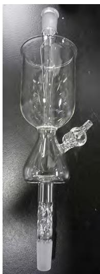
高価な試薬や貴重なサンプルなど、少量の液体を脱水・精製したいときに重宝します。
