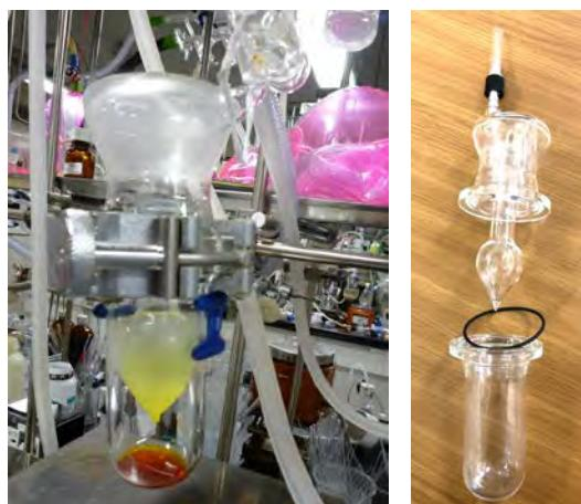
フランジの部分で2つのパーツに分かれます。試薬精製も反応物精製にも使えます。
